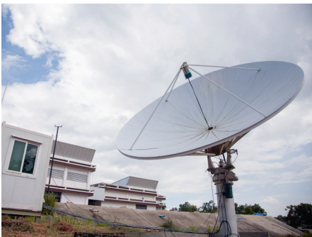
ภาพที่ 34 กล้องโทรทรรศน์วิทยุขนาดเส้นผ่านศูนย์กลาง 4.5 เมตร และห้องควบคุม (ตู้ทรงสี่เหลี่ยมด้านข้างกล้อง) ณ อุทยานดาราศาสตร์สิรินธร จังหวัดเชียงใหม่
