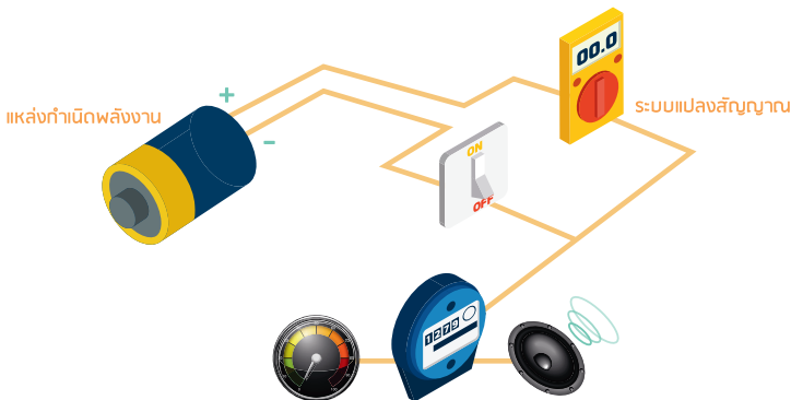
ภาพแสดงการทำงานของเครื่องวัดปริมาณรังสี
